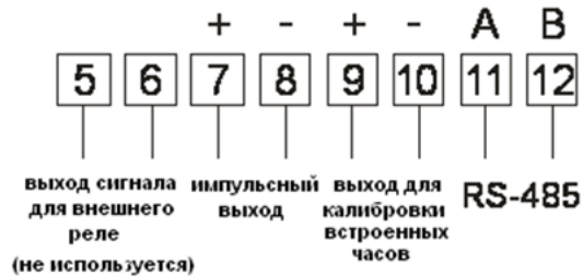
Рис. 3 - Дополнительные контакты клеммной колодки.
